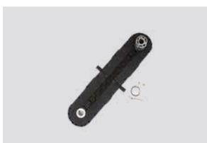
Kit renvoi de chaîne permettant de "déporter" le moteur de 485mm et réduisant l'écoîçon nécessaire à 150mm au lieu de 250mm lorsque le moteur est monté directement au bout de l'axe ressort.
