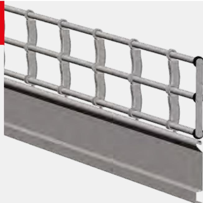
La grille à enroulement TUBOTUBE R (Renforcée) moteur central ISEAVERCOR est constituée de tubes droits de 14 mm reliés par des bielles en acier de 1,5 mm d'épaisseur. La distance entre tubes est de 63 mm et entre les bielles de 200 mm procurant à la grille une solidité parfaite. Tout cela constitue un tablier ultra rigide et silencieux.
