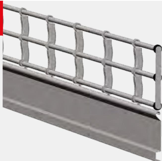
La grille à enroulement TUBOTUBE S (Simple) moteur tubulaire ISEAVERCOR est constituée de tubes droits de 14 mm reliés par des bielles en acier de 1,5 mm d'épaisseur. La distance entre tubes est de 63 mm et entre les bielles de 400 mm procurant à la grille une solidité parfaite. Tout cela constitue un tablier ultra rigide et silencieux.
