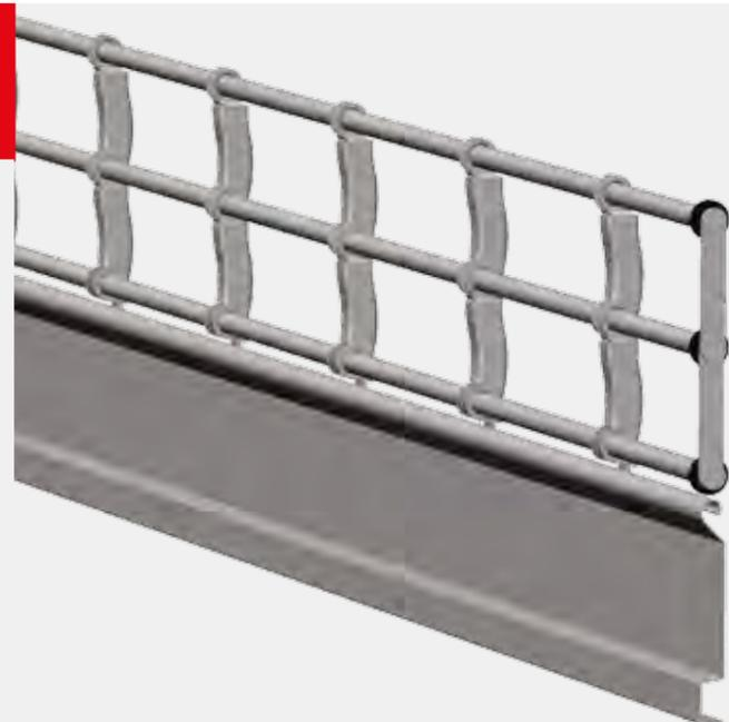
La grille à enroulement TUBOTUBE S (Simple) manuelle ISEAVERCOR est constituée de tubes droits de 14 mm reliés par des bielles en acier de 1,5 mm d'épaisseur. La distance entre tubes est de 63 mm et entre les bielles de 400 mm procurant à la grille une solidité parfaite. Tout cela constitue un tablier ultra rigide et silencieux.
