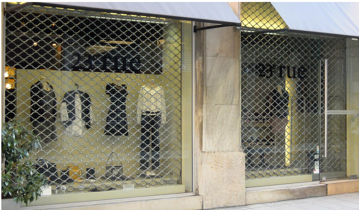
La grille à enroulement Tubonda S (Simple) ou R (Renforcée) répond parfaitement aux exigences de la sécurisation d'un magasin. Elle offre une visibilité maximale sur votre vitrine, avec un vide d'air de 70 %, tout en la protégeant efficacement de l'effraction. Le tablier est constitué de tubes en acier galvanisé ondulés de 14 mm reliés entre eux par des attaches également en acier galvanisé. La lame finale est renforcée en acier galvanisé 20/10°.
