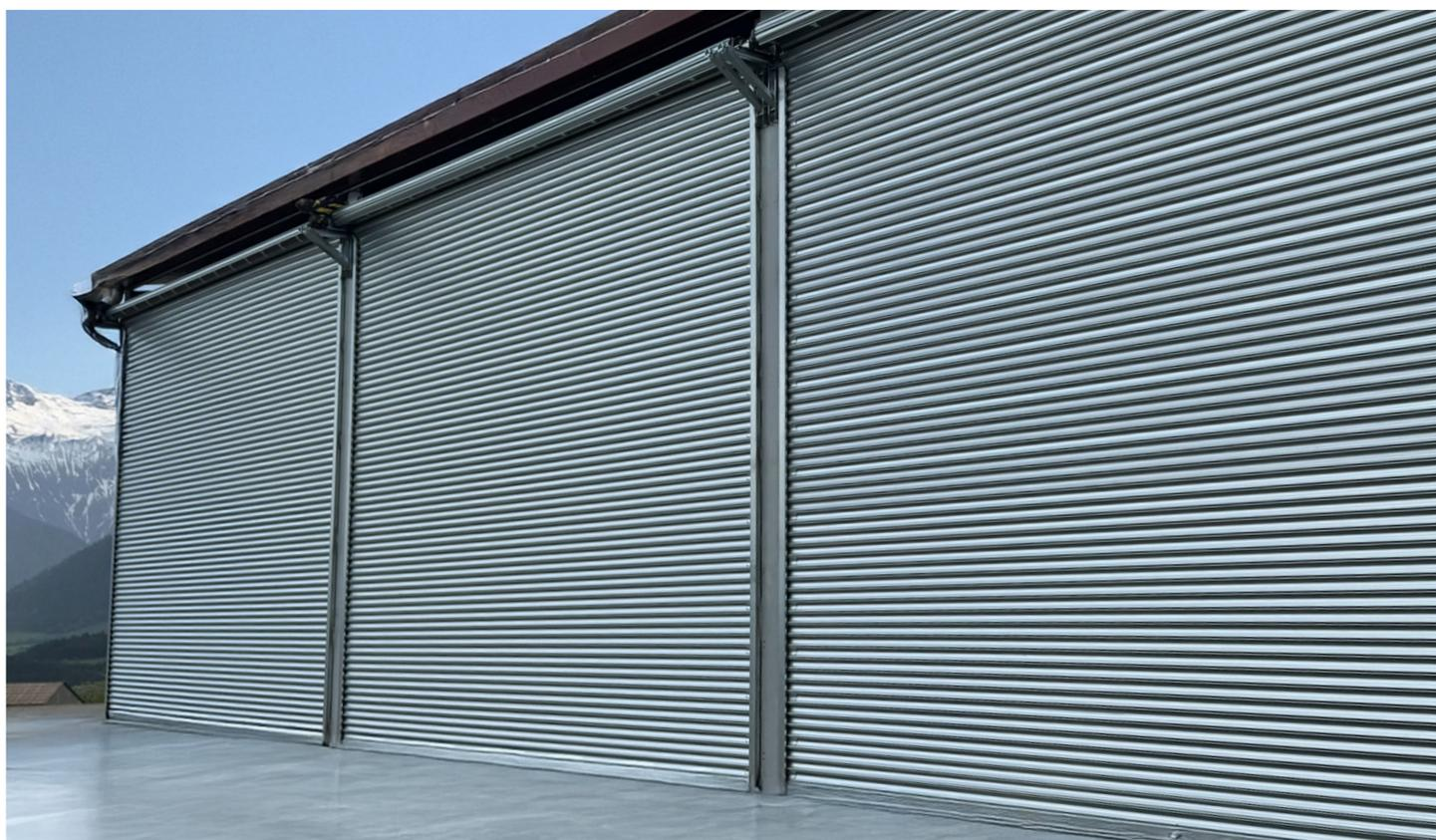
Par leur forme bombée, les lames du rideau P97 gagnent en rigidité. Ce type de rideau est parfaitement adapté à un usage commercial ou industriel. Le tablier très résistant est constitué de lames en acier galvanisé à chaud d'un pas de 97 mm fortement bombées, donnant une rigidité incomparable et d'un soubassement renforcé (20/10<sup>e</sup>). Le tablier est disponible en 7/10<sup>e</sup> et 9/10<sup>e</sup>.
