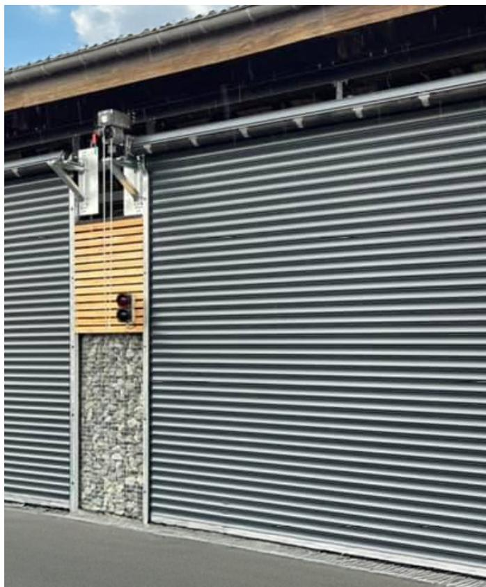
DP106 est un rideau à lames isolées constituées d'une double paroi en acier 4/10° injectées de mousse polyuréthane. Il est particulièrement adapté pour sécuriser et isoler les bâtiments industriels. Son tablier en lames isolées de 20mm d'épaisseur offre une excellente isolation thermique et acoustique.
