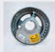
Permet de stopper le tablier en cas de chute de celui-ci. Le parachute est obligatoire avec les axes compensés comportant moins de 3 boîtes à ressorts. Il est intégré au moteur pour les axes compensés motorisés.
